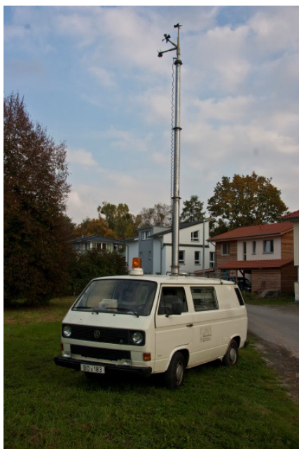
Abb. 5 Klimamessfahrzeug während eines Einsatzes in Soest
