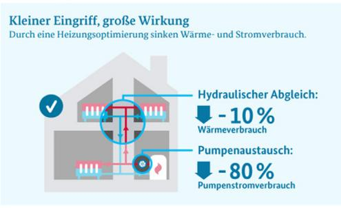
Abbildung 1: Wirkung von Heizungsoptimierung (Quelle: <https://kurzelinks.de/1wcm>)
