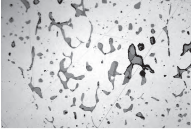
Abb. 21 Gefügebild einer Quaderschlacke. Metalleinschluss (glänzend weiss) mit einem Sulfidnetzwerk (hellgrau). Lichtmikroskopische Aufnahme bei 200facher Vergrößerung. Stralsund, MV.
