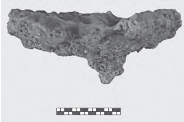
Abb. 20 Bockhart. Schmiedeschlacken. Typische Querschnittsform (zentraler Zapfen, flacher Kalottenkörper) für ein einfaches Schmiedefeuer.
