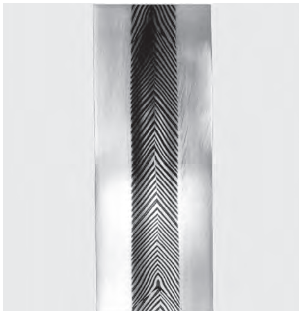
Abb. 8 Ein Detail aus der Blattmitte zeigt das Damastgefüge und die Ausrichtung seines Winkels auf den Ort. M 1:2.
