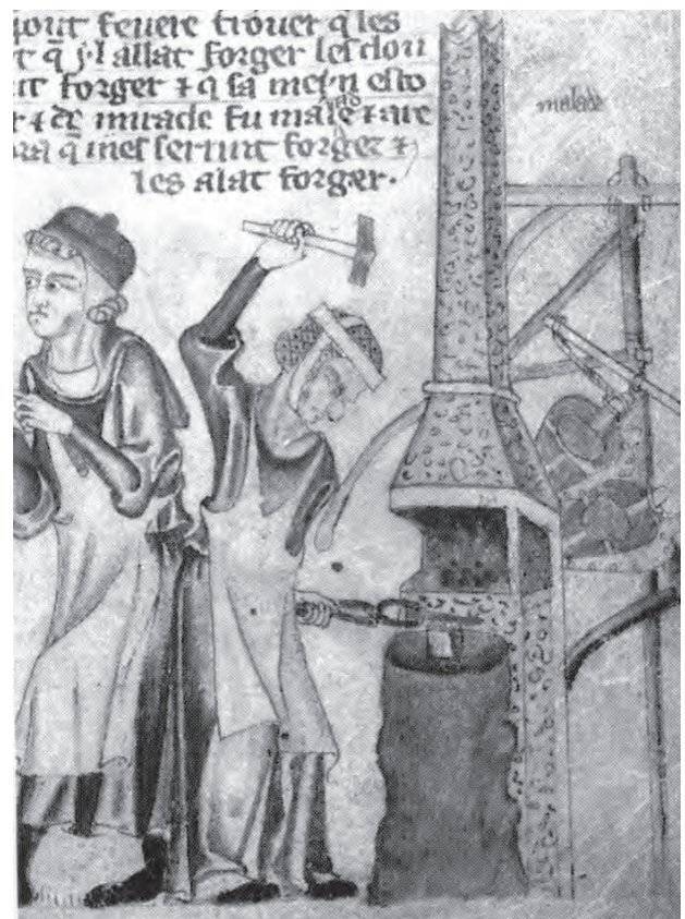
Abb. 5 Holkham Bible. Esse mit Befestigungsvorrichtung für einen Blasebalg.
