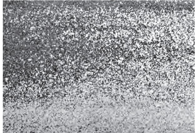
Abb. 4 Übergang ungehärtetes – gehärtetes Gefüge. M 30:1.
