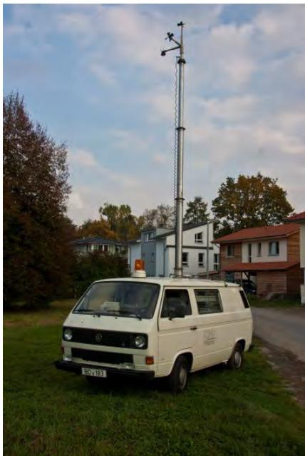
Abb. 5 Klimamessfahrzeug während eines Einsatzes in Soest
