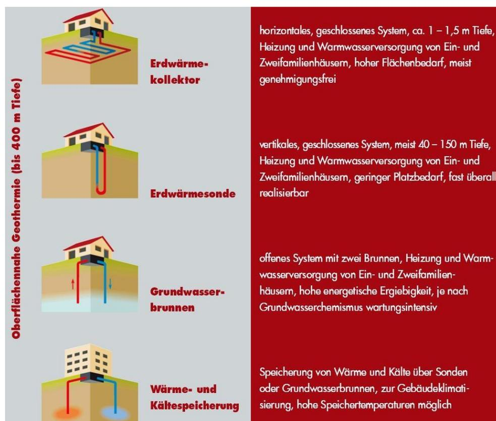
Abbildung 61: Nutzungsmöglichkeiten oberflächennaher Geothermie<sup>20</sup>
